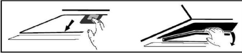
Bevestig het actiefkoolfilter in het apparaat en draai het rechtsom. Doe hetzelfde aan de andere kant.
