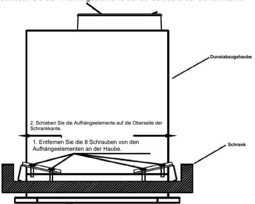
3. Schrauben Sie die 4 Aufhängeelemente mithilfe der 8 (zuvor in Schritt 2 entfernten) Schrauben an die Dunstabzugshaube.
