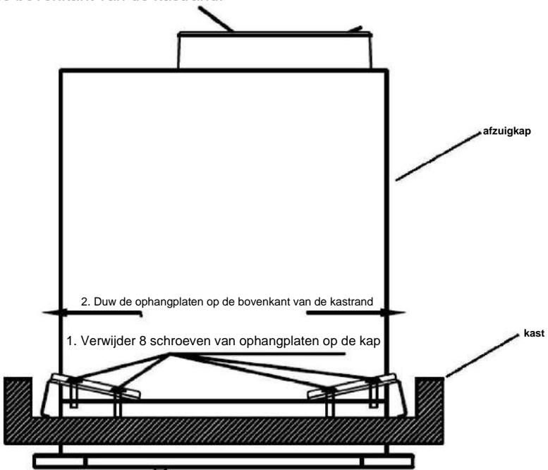
3. Schroef 4 ophangplaten op de afzuigkap met 8 schroeven (eerder verwijderd in stap 2).
