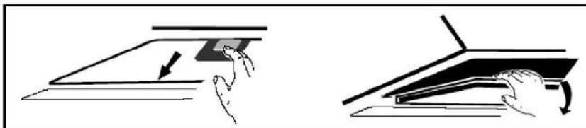
Enfilez le filtre à charbon actif dans l'appareil et faites-le tourner en sens horaire.
