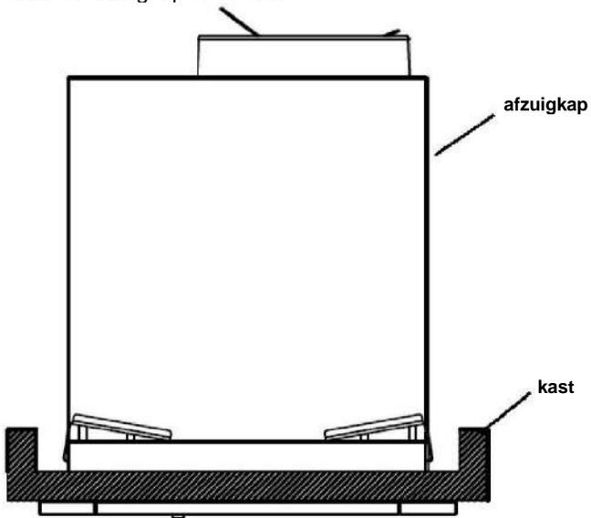
2. Verwijder 8 schroeven van 4 ophangplaten in de afzuigkap, druk de 4 hangplaten op de bovenkant van de kastrand.
