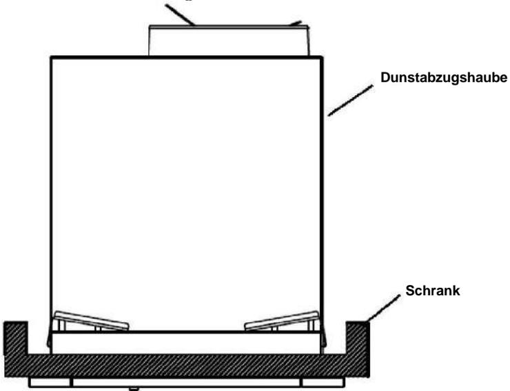
2. Entfernen Sie die 8 Schrauben der 4 Aufhängeelemente an der Dunstabzugshaube und schieben Sie die 4 Aufhängeelemente auf die Oberseite der Schrankkante.
