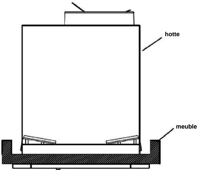
2. Retirez les 8 vis des 4 plaques suspendues de la hotte, poussez les 4 plaques suspendues dans le haut du bord du meuble.
