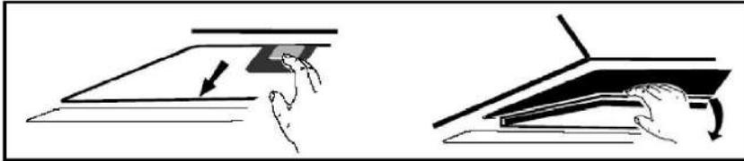
Stecken Sie den Aktivkohlefilter in das Gerät ein und drehen Sie ihn im Uhrzeigersinn. Wiederholen Sie den Vorgang auf der anderen Seite.
